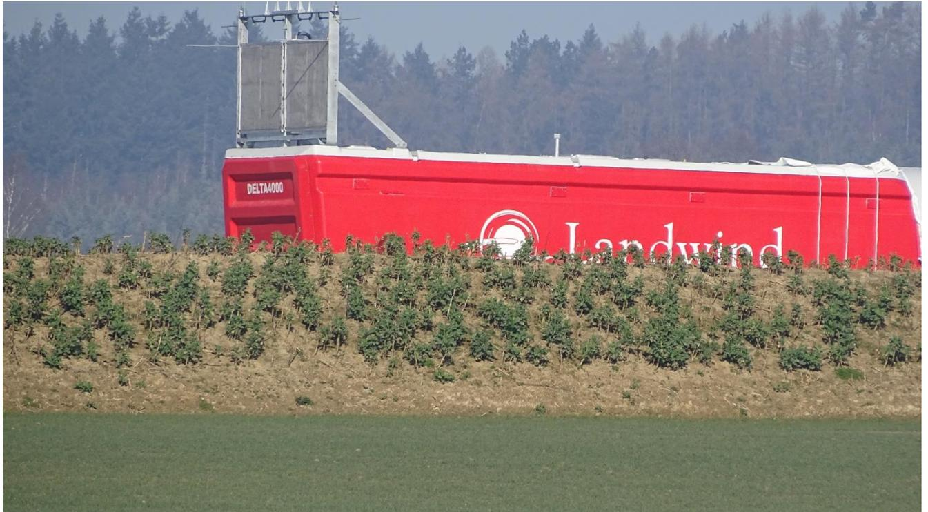
*Das Maschinenhaus (Gondel) in Warteposition. Das Gesamtgewicht der Gondel mit Rotorblättern beträgt rund 140 Tonnen.*
